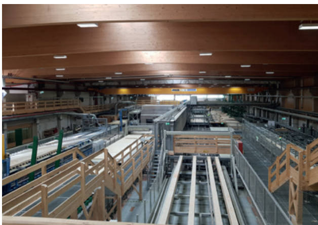
BSP-Fertigungslinie: Das Prokon-Modul erlaubt eine Vernetzung sämtlicher Maschinen in einem System
