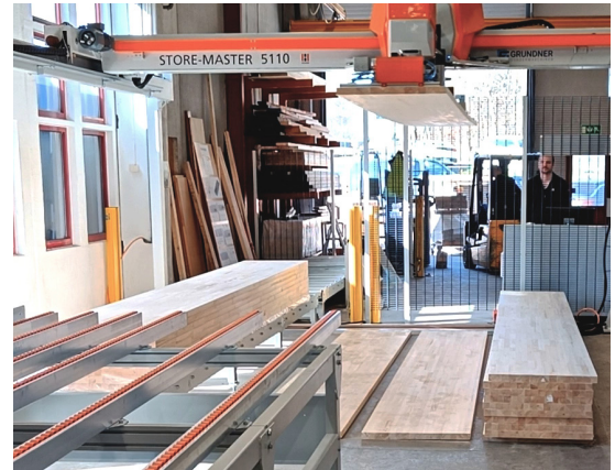
Der Kran verteilt als erstes die Platten auf fünf Stapel gleicher Größe und gleichen Materials.
