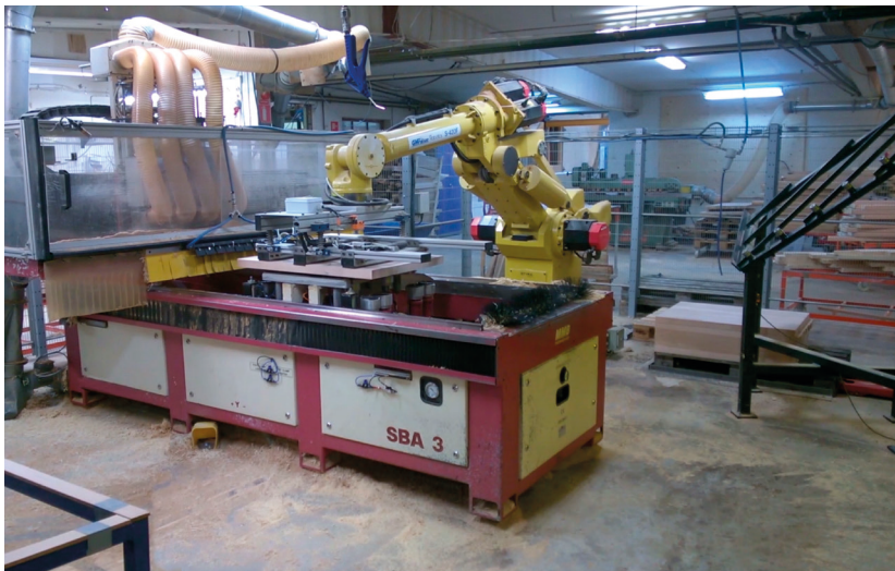
Die SBA 3 mit Roboterbeschickung in Aktion – zu sehen im Video: http://tiny.cc/CS-SBA3
