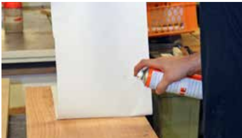
Treppenbauer ohne CNC-Maschinen können trotzdem die Vorteile der CAD Module nutzen. Entwürfe können auf 1:1-Schablonen für die manuelle Bearbeitung gedruckt werden.
