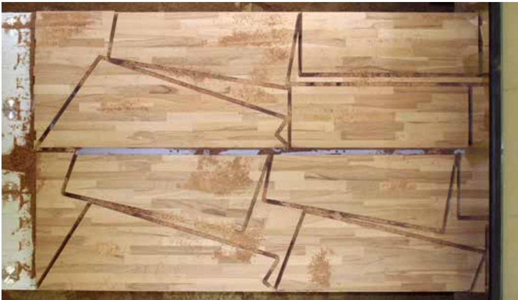
Nesting und Plattenoptimierung sparen Zeit und Material, was zu einem enormen Anstieg der Effizienz führt und Kosten senkt.
