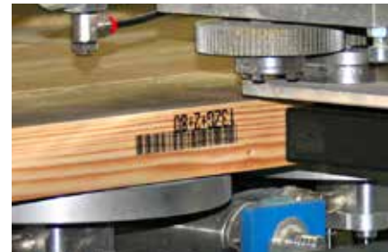
Barcodeverwaltung des ganzen Prozesses führt zu mehr Effizienz, weniger Verwaltungsaufwand und unterstützt den nahezu vollautomatischen Fertigungsprozess.
