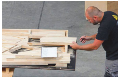
/ Die Bauteile können nun aus der Platte gelöst, beschriftet und bei Bedarf manuell nachgearbeitet werden.
