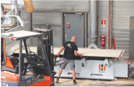
/ Der Bediener belädt die CNC-Maschine mittels eines Gabelstaplers mit der Massivholzplatte.
