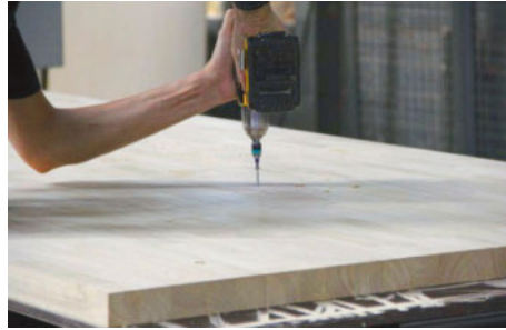
/ Nach dem Ausrichten verschraubt der Maschinenbediener die Massivholzplatte mit der Verlustplatte.
