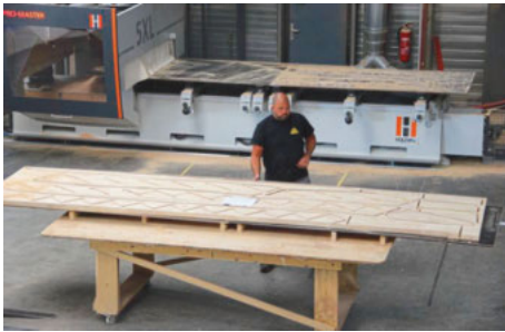
/ Nach der Bearbeitung wird die Platte auf einen Rolltisch geschoben, der gleich hoch wie der Maschinentisch ist.
