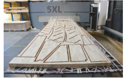
/ So können auch kleine Teile optimiert werden, die durch Vakuumsauger ansonsten nicht fixiert werden.
