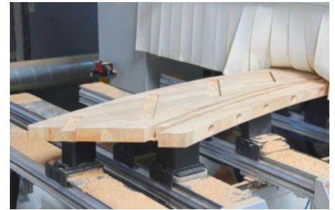
/ Größere Teile wie Wangen oder Handläufe werden nun auf der Maschine fertiggestellt.
