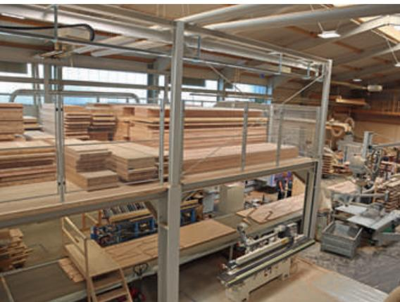
Das Lager wurde im 2. Stock installiert, die Platten werden von einem Kran automatisch entnommen
