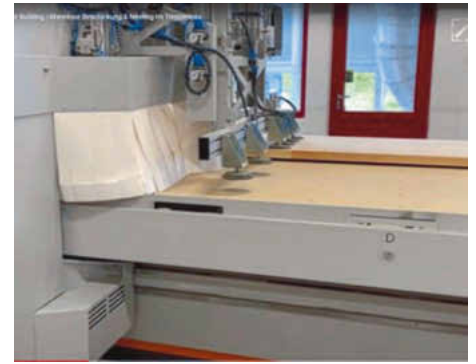
/ Die Dynestic 7535R von Holz-Her zieht die Platte automatisch mit Saugern auf den Arbeitstisch
