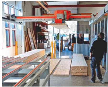
/ Der von Compass Software gesteuerte Kran verteilt die Platten im Lager und lädt sie auf das Förderband.
