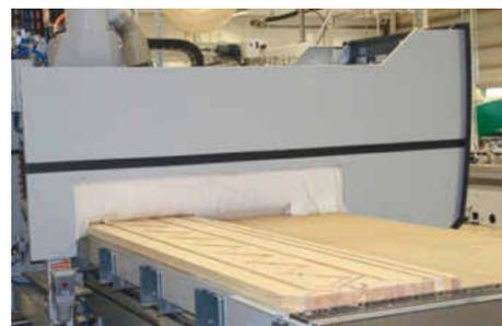
*/ Etwa die Hälfte aller Teile ist nach dem Nestingprozess bereits fertig bearbeitet.*
