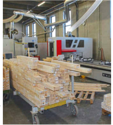
/ Die Maschinen werden direkt über die Treppenbau- software angesteuert und ermöglichen eine ...
