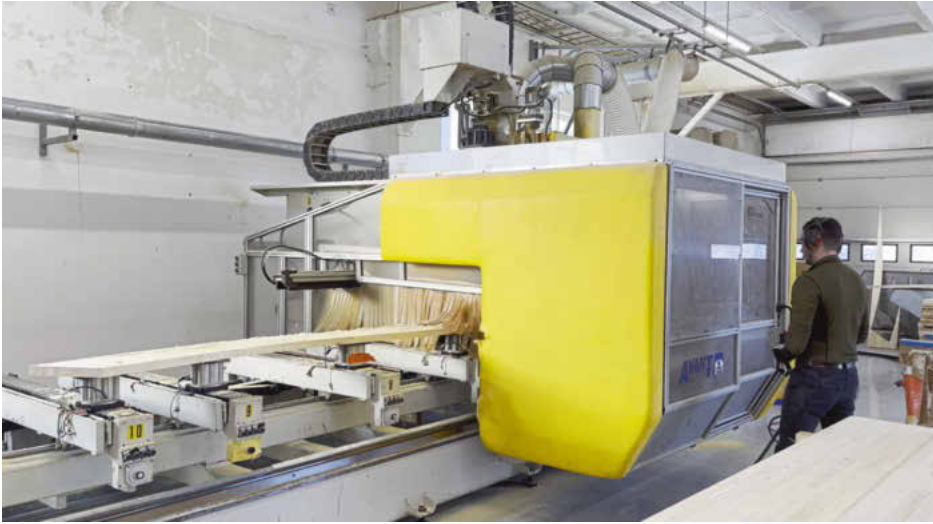
/ Aru Grupp setzt in der Treppenproduktion acht CNC-Maschinen verschiedener Hersteller ein, die alle mit Compass Software gesteuert werden.
