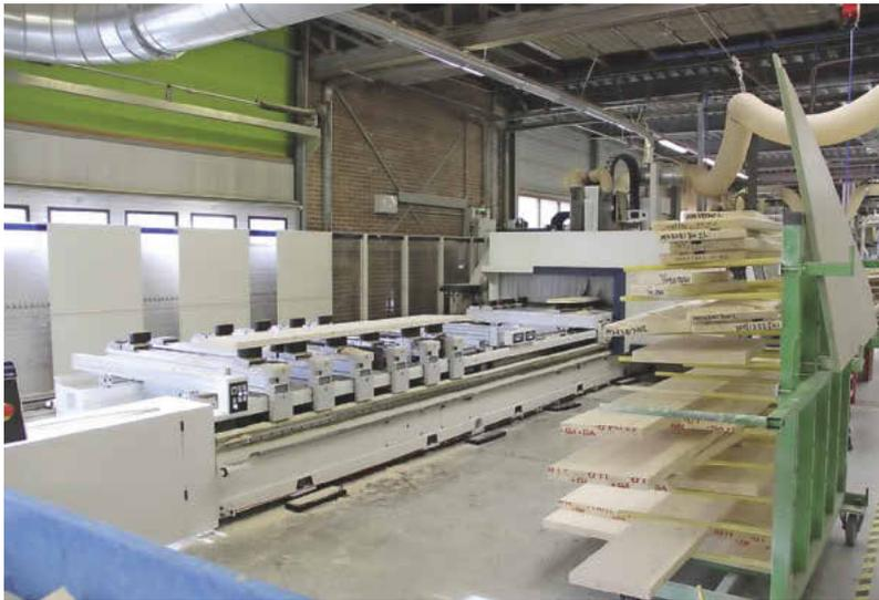
Alle Teile einer Treppe bleiben in der Fertigung zusammen. De Vries rechnet im Schnitt mit einer Durchlaufzeit von nur drei Arbeitstagen pro Treppe
