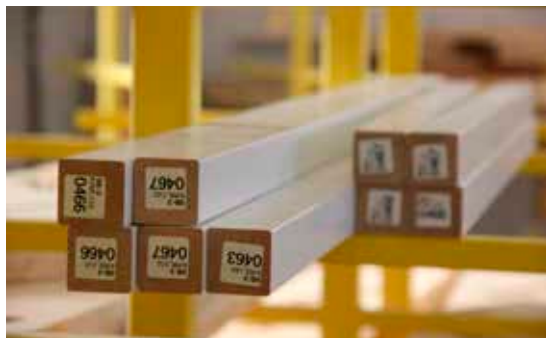
RFID-kiibid treppide komponentidel võimaldavad täielikku jälgitavust ja läbipaistvust tootmises.
