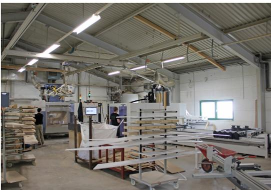
2019 folgte eine zweite CNC-Maschine, diesmal eine HOMAG mit 5 Achsen.
