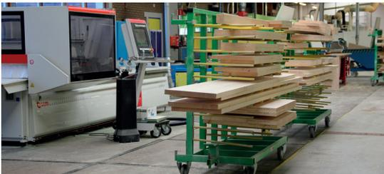
Vom Auftragseingang bis zur Auslieferung wird die gesamte Produktion auf komplette Fertigungsaufträge ausgerichtet. Dabei bleiben alle Teile einer Treppe in einer Gruppe zusammen.
