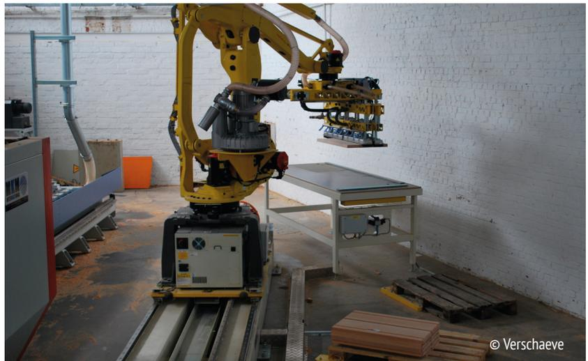
Anfang 2019 hat das Unternehmen das vierte CNC-Bearbeitungszentrum gekauft, dieses Mal mit integriertem Fanuc Roboter für die Beschickung.
